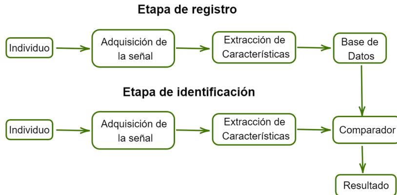
Figura 3.1: Etapas de registro e identificación en un sistema biométrico.
