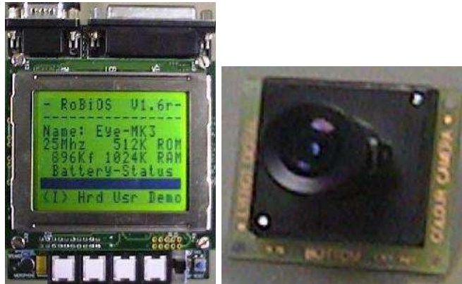
Figura 2.8: Tarjeta Eyebot (izquierda) y cámara EyeCam compatible con EyeBot (derecha). La tarjeta EyeBot se usa para aplicaciones sencillas de visión y maneja algunos motores. Figura tomada de Eyebot (Diciembre 2008)
