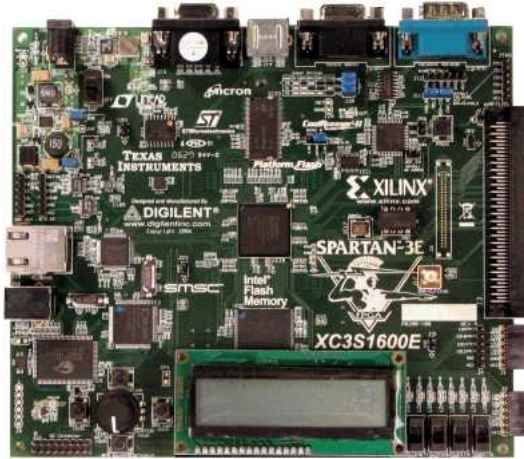
Figura 5.4: Tarjeta FPGA SP3E1600E MicroBlaze Edition, de la empresa Xilinx. Figura tomada de Xilinx (Diciembre 2008)
