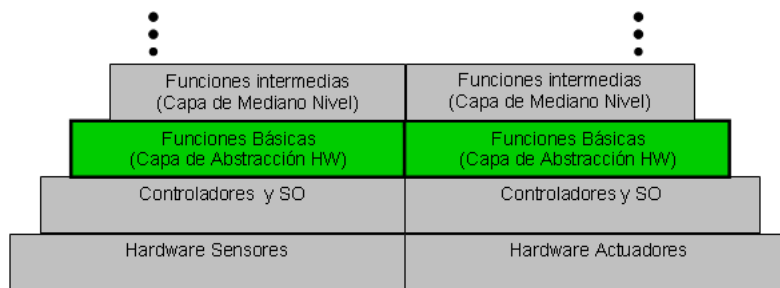
Figura 4.7: Arquitectura software: capa Funciones Básicas. En esta capa se tiene acceso al hardware mediante funciones que sean fáciles de usar para la mayoría del los programadores de robots
