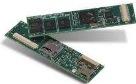
Figura 2.7: Tarjeta Gumstix utilizada como computadora pequeña de propósito general, es pequeña y liviana. Gumstix es parecida a la KoreBot, sólo que esta última está orientada mayormente para aplicaciones robóticas. Figura tomada de Gumstix (Diciembre 2008)
