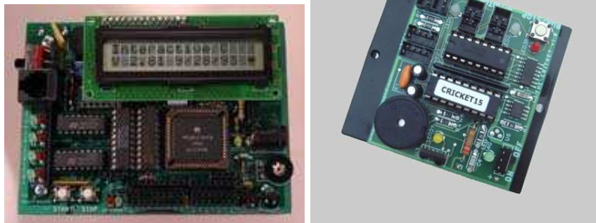
Figura 2.3: Tarjeta Handy Board (izquierda) y una versión simplificada llamada Handy Cricket (derecha). Ambas tarjetas son usadas como controladores de robots, sirven para aplicaciones de mediano nivel en donde no se requiere procesar grandes cantidades de datos, como por ejemplo en algunos algoritmos de visión por computadora como la recuperación en 3D, extracción de movimiento y seguimiento multiobjetivo, entre otros. Figura tomada de HandyBoard (Diciembre 2008)
