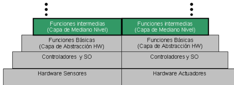
Figura 4.9: Arquitectura software: capa Funciones Intermedias. En esta capa se tienen funciones que involucran un conjunto de acciones o comportamientos más elaborados para cierto robot
