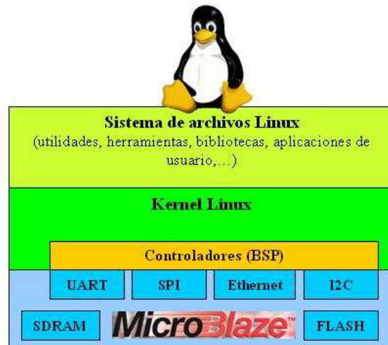
Figura C.3: Diagrama de una arquitectura software con Linux empotrado en un FPGA. El BSP es el que se encarga de la comunicación con los periféricos hardware. Figura basada de Avnet (Octubre 2007)
