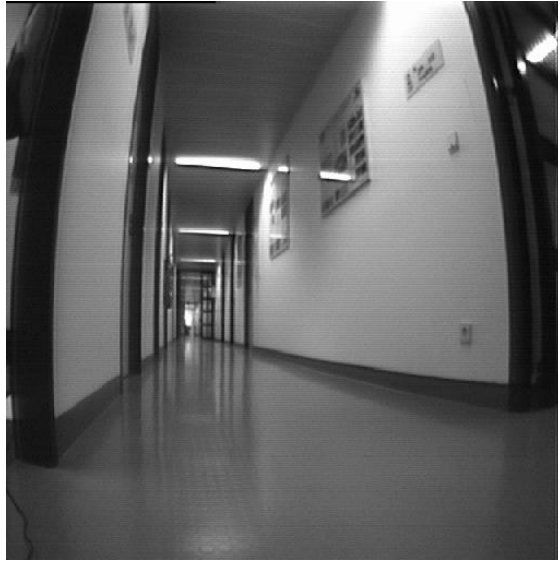
Figura 2.4a. Imagen con distorsión radial.
