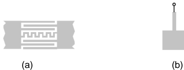
Figura 2.10 (a) Resonador de elementos agrupados, (b) Resonador de cuasi elementos agrupados [2.6].
