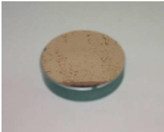
Figura 3.15: Imagen de espejos de 60 mm de diámetro fabricado en el taller de óptica del INAOE.
