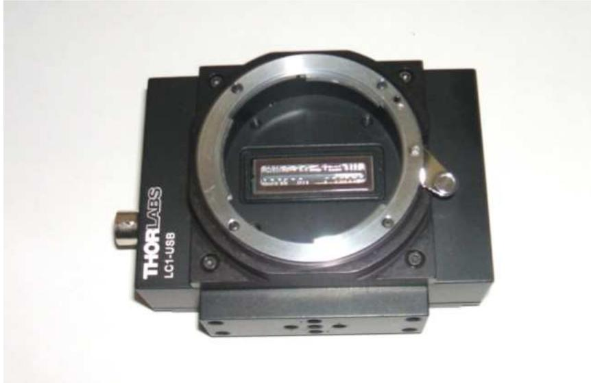
Figura 3.10: Arreglo lineal de CCD LC1-USB de Thorlabs
