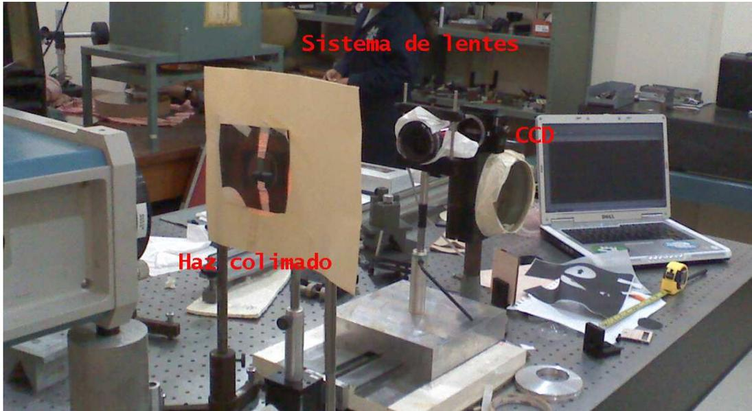
Figura 4.15: Montaje experimental hecho en el laboratorio del taller de óptica del INAOE. El haz colimado procede de la parte izquierda en la imagen.
