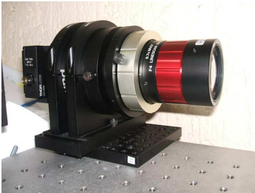
Figura 3.9: Sistema de lentes de enfoque Edmund con su montura y acoplado a una cámara CCD
