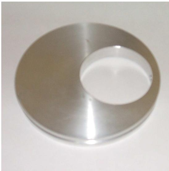
Figura 3.12: Pieza para ajuste de montura de expansor de haz construida en el taller mecánico de INAOE.
