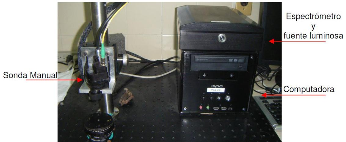
**Figura 2.2.** Partes del equipo SR-OCT930 el equipo consta de una computadora, una fuente de iluminación, un espectrómetro y la sonda manual.
