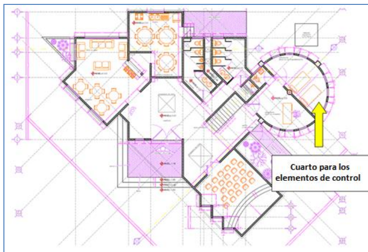
IMAGEN 5 - UBICACIÓN DE CUARTO EN EL VISITOR CENTER Y QUE ALOJA LOS ELEMENTOS DE CONTROL DEL SISTEMA DE MONITOREO METEOROLÓGICO
