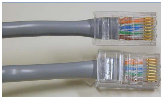
IMAGEN 7 – CABLE TIPO ETHERNET CAT5 CON CONECTOR RJ-45
