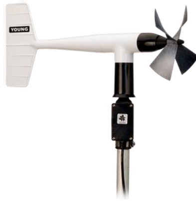
IMAGEN 4 – ANEMOMETRO YOUNG UTILIZADO EN PRUEBAS DE LABORATORIO Y EN LAS INSTALACIONES DEL GRAN TELESCOPIO MILIMETRICO PARA LECTURA A/D CON RASPBERRY PI
