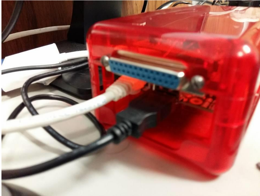
IMAGEN 25 – CONEXIÓN FINAL DE RASPBERRY PI Y TARJETA A/D Y AMPLIFICADORA CON CONEXIÓN A PC
