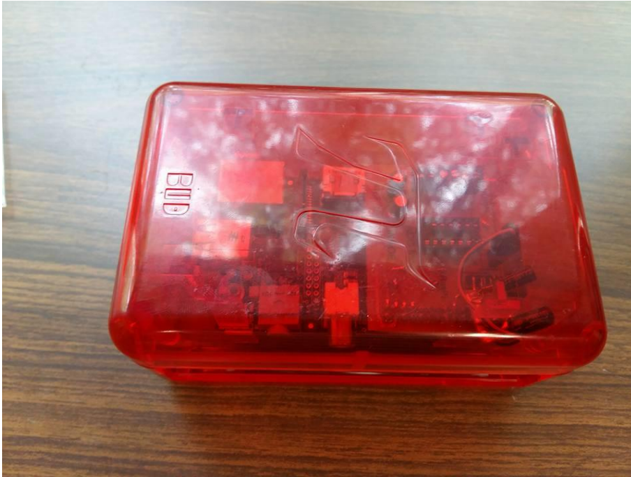
IMAGEN 10 – ENCAPSULADO COMPLETO DE TARJETA RASPBERRY PI, MODULO ADC Y BOOSTER CON CONECTIVIDAD A PC
