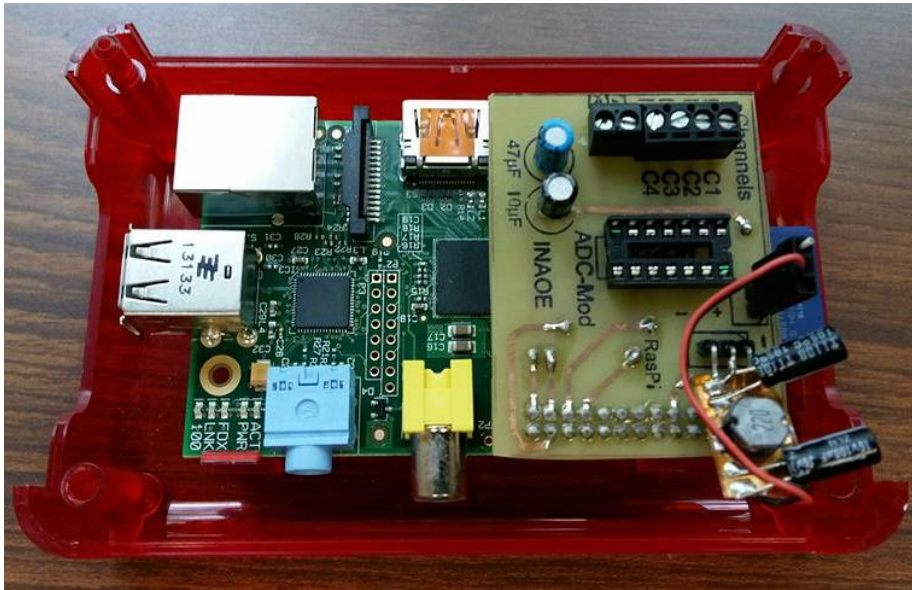
IMAGEN 9 – MÓDULO ADC INSERTADO A RASPBERRY PI
