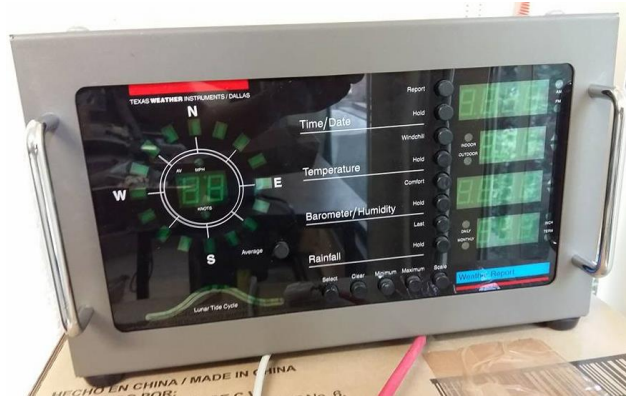
IMAGEN 5 – DATA LOGGER TEXAS WEATHER INSTRUMENTS UTILIZADO EN PRUEBAS DE LABORATORIO Y EN LAS INSTALACIONES DEL GRAN TELESCOPIO MILIMETRICO PARA LECTURA A/D CON RASPBERRY PI
