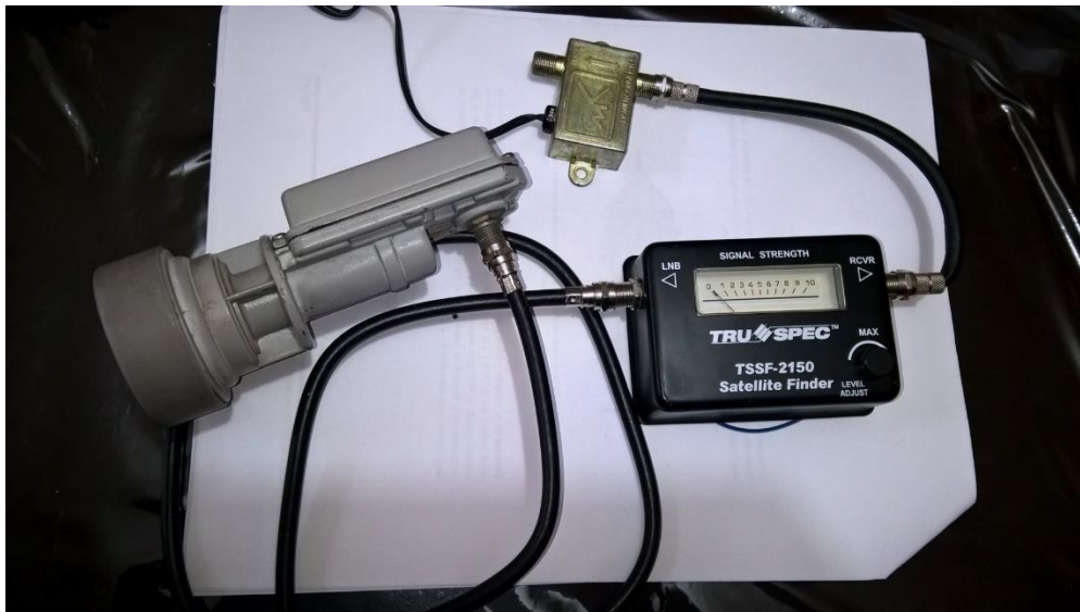
Figura 5. Conexión para verificar la respuesta del LNB ante diferentes estímulos.
