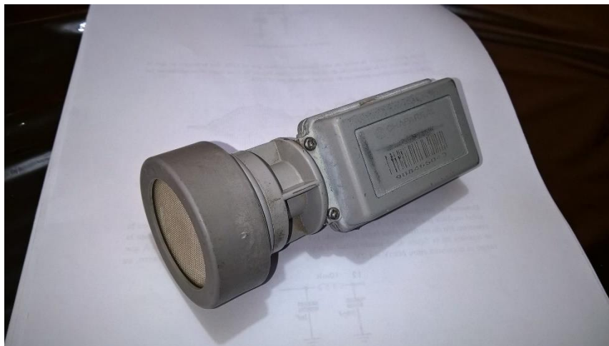
Figura 1. LNB universal de la marca Chaparral.
