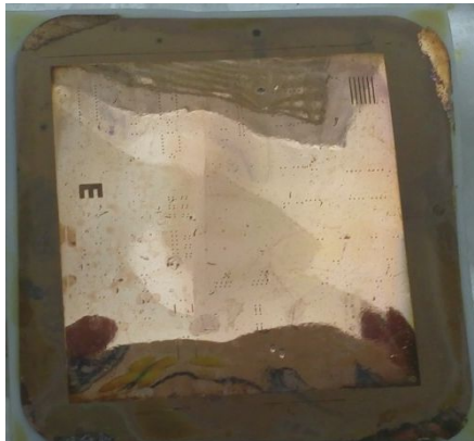
Figura 4.12.- Enmascaramiento para grabar el BCB
