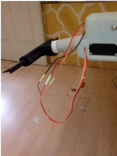
Ilustración 113. Cableado de la articulación 4
