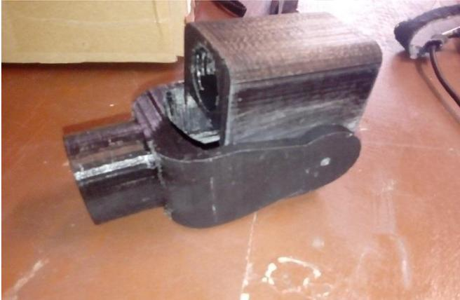
Ilustración 95. Articulación 2 del brazo robótico
