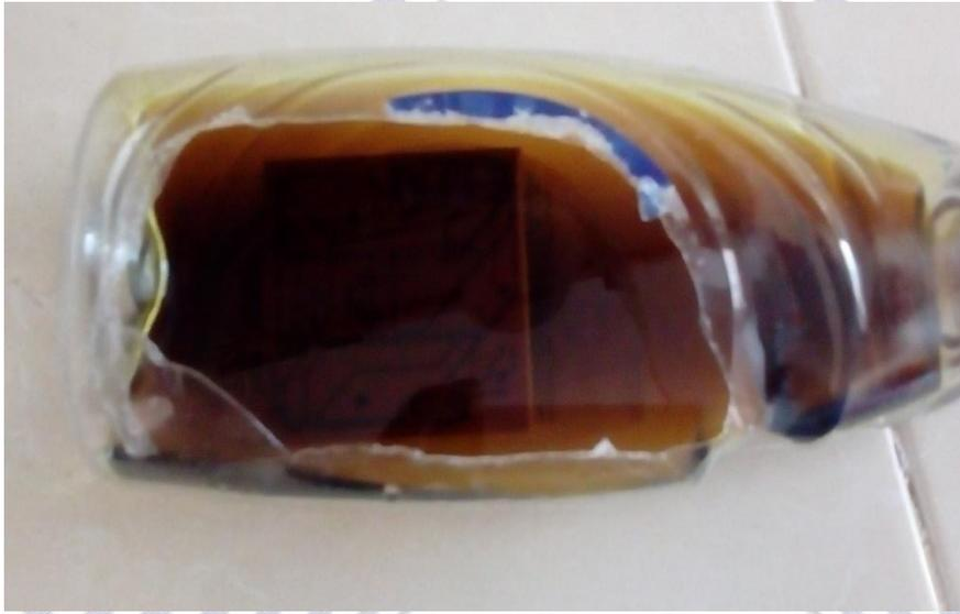
Ilustración 84. Placa dentro del Cloruro férrico
