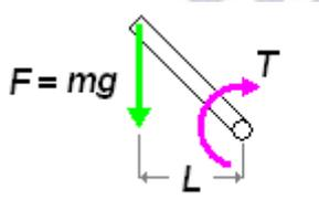
No existe torque cuando la longitud del eslabón no esté en forma perpendicular a la fuerza aplica, ya que la fuerza seria sobre la misma dirección del eslabón y la suma de torque seria "Cero", como se ilustra a continuación.
