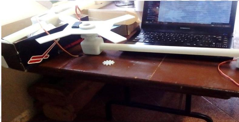
Ilustración 93. Armado de la base con la extensión del brazo robótico
