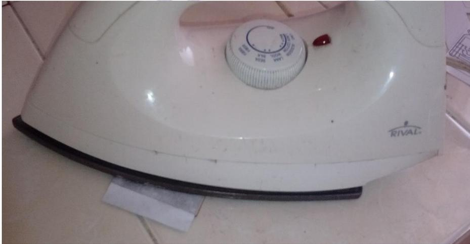
Ilustración 83. Planchado del Circuito PCB.
