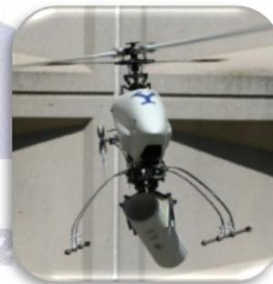
**2011** Aeronave diseñada con un actuador tipo Garra o gripper, para la sujeción o agarre en el aterrizaje [9]
