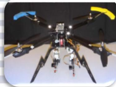
**2014** Quadrotor equipado con un simple manipulador Se emplea para demostrar la Técnicas. [11]
