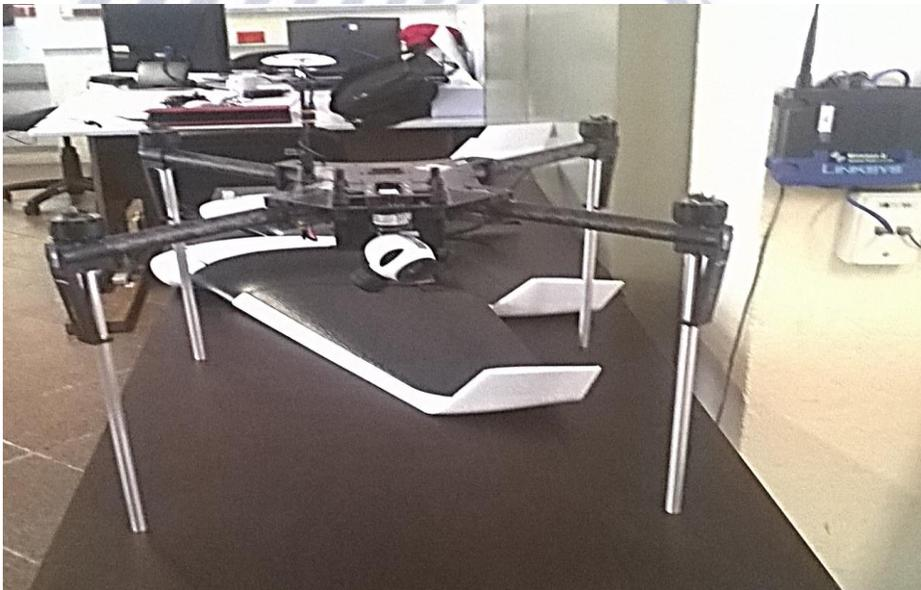
Ilustración 40. Dron Matrice 100 con patas de aterrizaje Modificado
