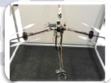
Aplicación: abrir y cerrar un cajón mediante un manipulador con un manipulador de 3 DoF.
