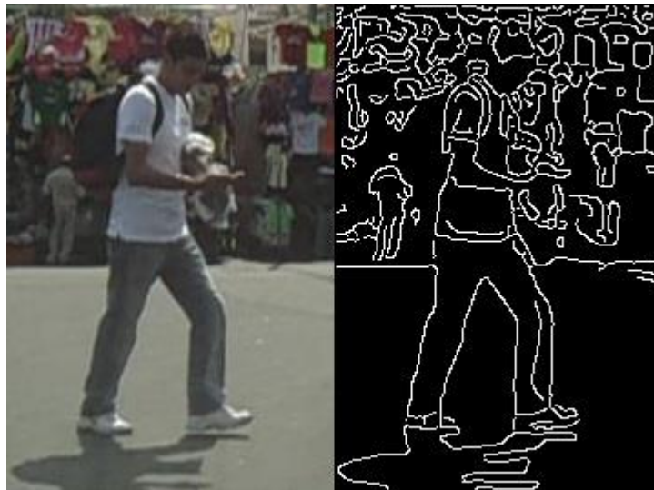
Figura 3.5: Imagen obtenida con el algoritmo Canny
