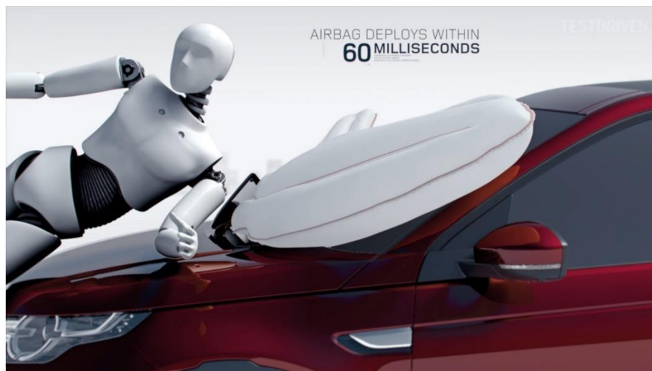
Figura 2.4: PPS implementado en la Land Rover® Discovery 2015 [10]
