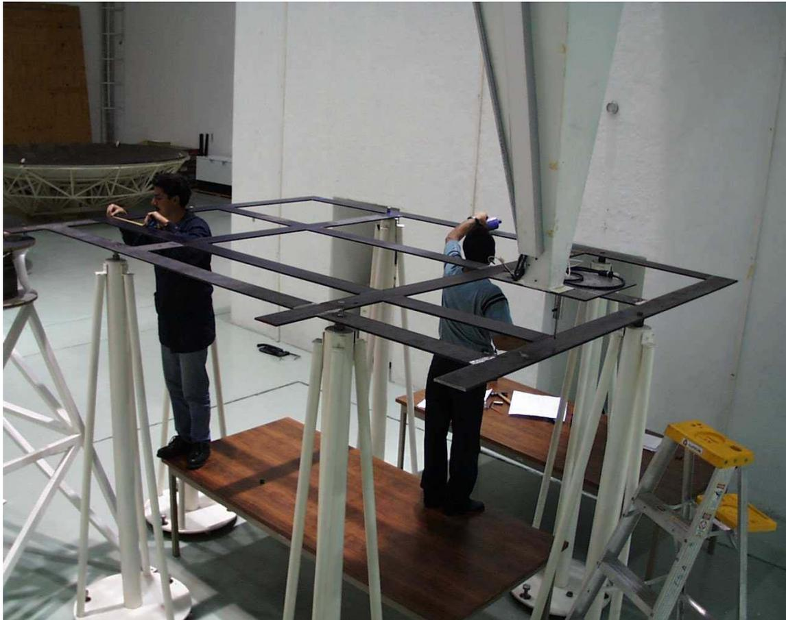
*Figura 7. Alineando la plantilla en el área de trabajo de la máquina de medición. El punzón está visible colgando de la placa horizontal en la cabeza de la máquina.*
