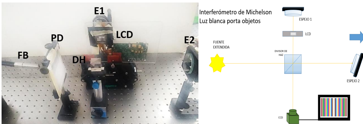
Figura 4.11 Arreglo esquemático y experimental del interferómetro de Michelson con luz blanca y con una pantalla de cristal líquido en uno de sus brazos.
