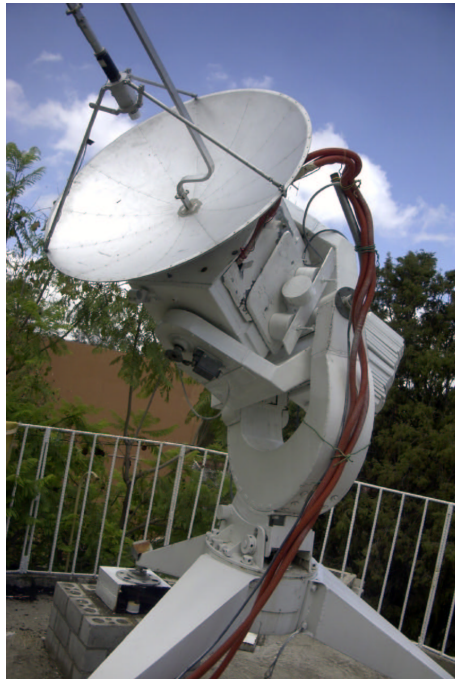
Figure 4: Radiotelescopio solar del INAOE en su montura original.
