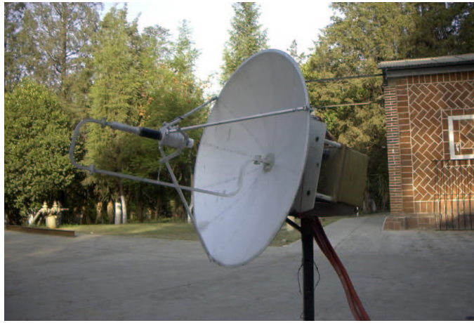
Figure 5: Antena en una montura para girarla en azimuth.
