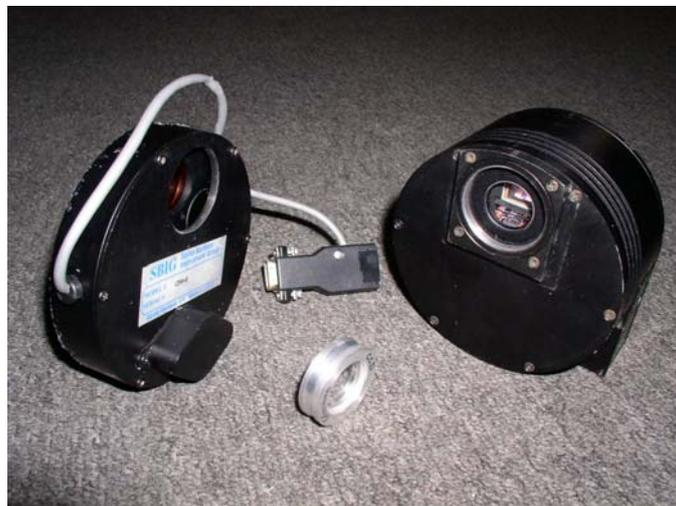
Imagen # 3.- Se muestran las tres partes fundamentales colocadas en la caja de duraluminio de izquierda a derecha: Carrusel de filtros, Lente Aplanadora de Campo y el CCD-ST8.
