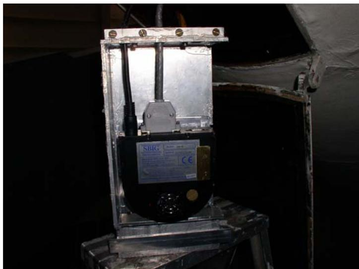
Fig.#5.:Se muestra la colocación del CCD en la caja sellada y del lado opuesto, esta atornillado el Carrusel de Filtros y entre ambos componentes está situada la Lente Aplanadora de Campo.
