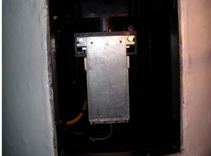
Imagen # 6.- Se muestra como va colocada la caja sellada, dentro están situados el CCD-ST8, por fuera, del otro lado, el Carrusel de Filtros, con la Lente Aplanadora de Campo entre ambos dispositivos colocada correctamente.
