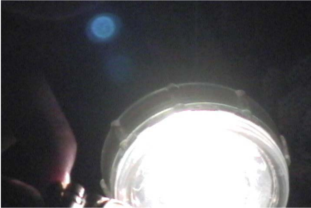
Figura 4. Imágenes fantasmas de 2 y 4 reflexiones, son una imagen del diafragma de abertura tomadas con una cámara de video JVC modelo DVL310
