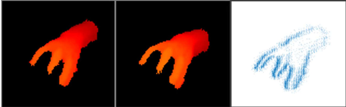
Figura 2.8 Ejemplo de flujo óptico, fotograma en un tiempo inicial, fotograma un tiempo después, campo vectorial del desplazamiento de cada pixel de la imagen.
