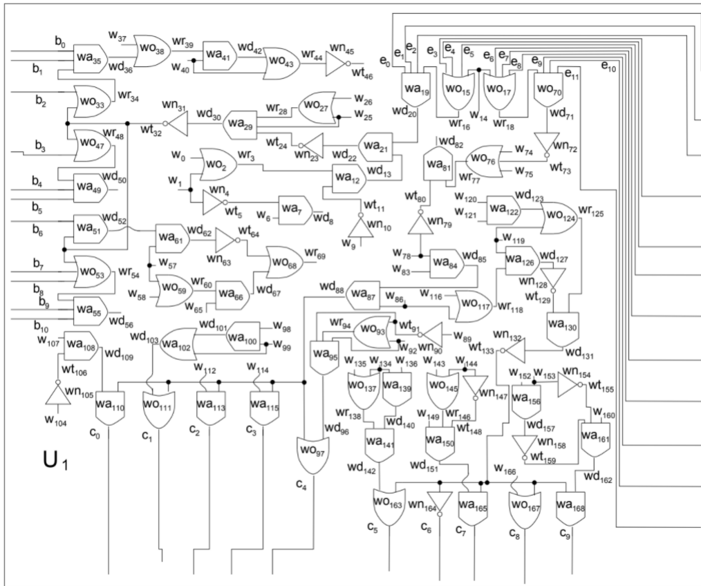
Figura 5.2: Diseño del circuito lógico del componente U1 del ejemplo 3.
