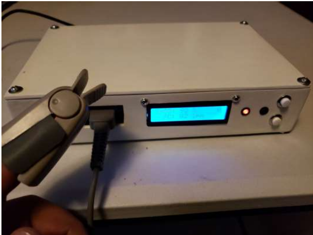
Figura 22. El oxímetro base funcionando. La imagen se tomó con una apertura de 1/125 para que se notara el display y se pudiera apreciar la medición, por eso se ve subexposto.
