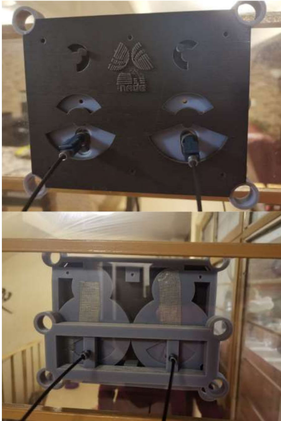
Figura 47. El acople V. La foto de arriba es el lado exterior, la de abajo el interior.
