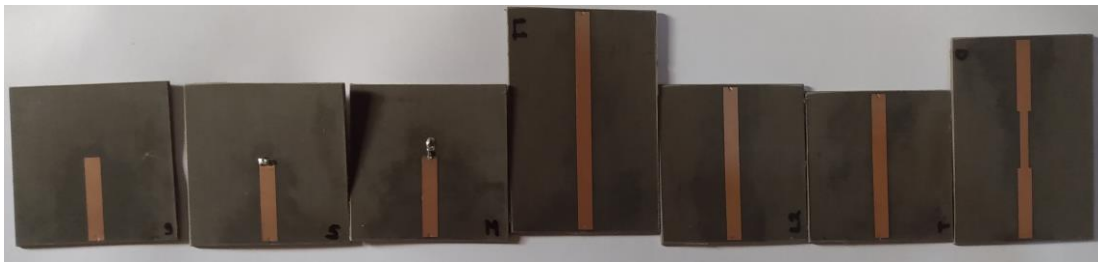
Figura 4.5. Estándares y DUT fabricados en DiClad 880, utilizados en las calibraciones TRL, LL, TRM y TRRM.
