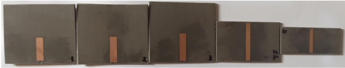
Figura 4.6. Estándares fabricados en DiClad 880 y DUT fabricado en DiClad 880, para las calibraciones SOLT, Robust SOLT y QSOLT.
