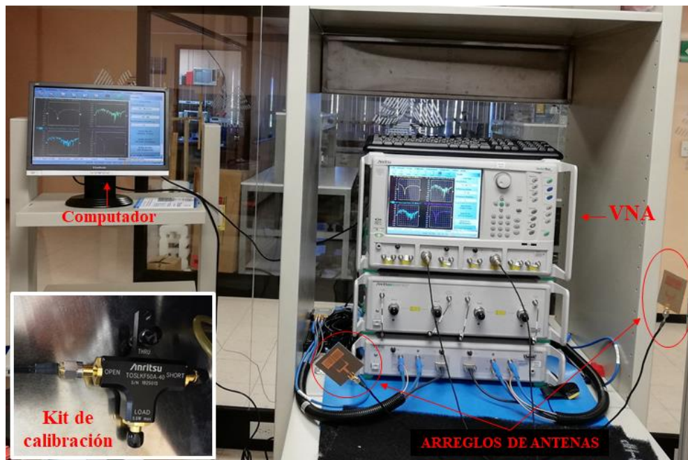
Figura 4.7 Medición de los parámetros S en el laboratorio de altas frecuencias en el INAOE.
