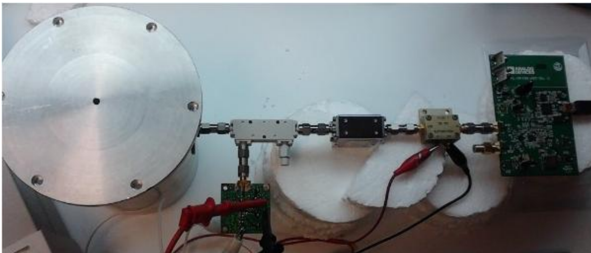
Figura 6.3 Sistema A implementado para la medición de la cavidad con y sin perturbación.
