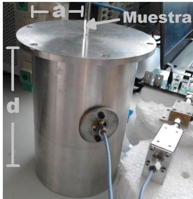
Figura 5.2 Cavity resonante cilíndrica fabricada.
