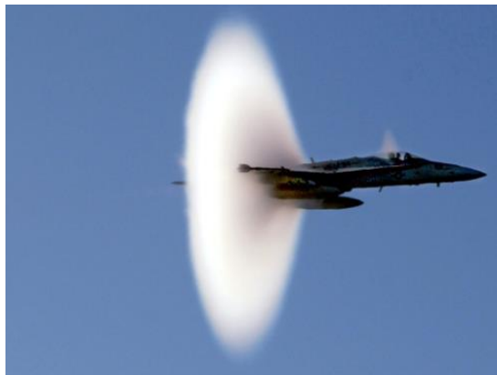
Fig. 3.3 Avión de combate con ondas de choque cónicas visibles por condensación [65].
