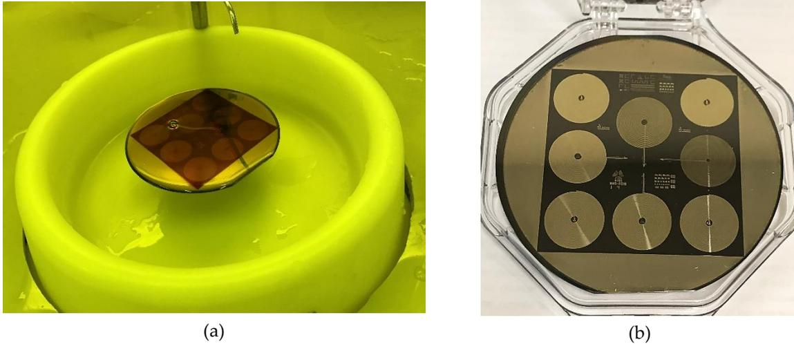
Figura 4.20. (a) Deposito de poliimida 2610 a 5000 rpm y (b) película de poliimida completamente curada y utilizada como material de recubrimiento para el conjunto de bobinas y encapsulado hermético para el arreglo de sensores.
