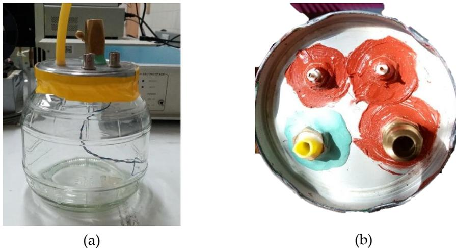
Figura 5.3. (a) Cámara de presión a base de un recipiente de vidrio y (b) tapa de aluminio con sus cuatro conectores herméticos.
