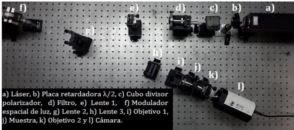
Figura 10. Arreglo experimental utilizado en los experimentos para lograr enfoque a través de una medio esparcidor.
