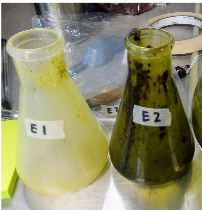
Figura 3.3: Extracción por fluidos súper críticos. E1: disolvente CO 2 . E2: disolvente Etanol.
