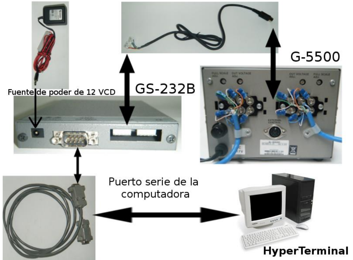
Figura 2.9. Esquema de conexión del sistema básico de manejo de la estación terrena.
