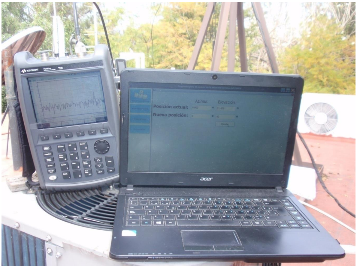
Figura 4.2. Analizador de microondas junto a la interfaz gráfica del sistema AminiSAT.
