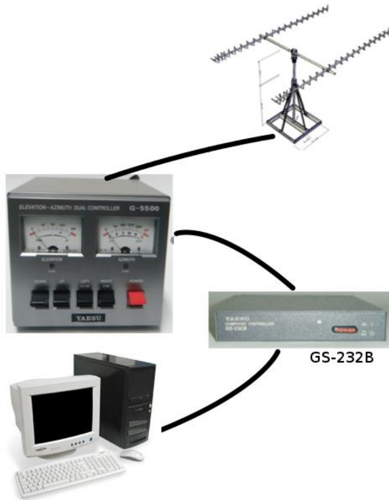
Figura 3.3. Esquema de interconexión del sistema básico.
