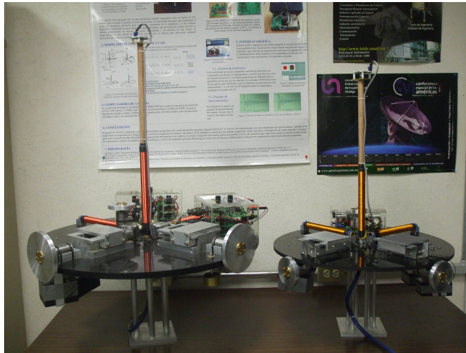
Figura 1.4: Simulador vuelo satelital para la validación experimental de la orientación de satélites desarrollado en la UNAM.[?]
