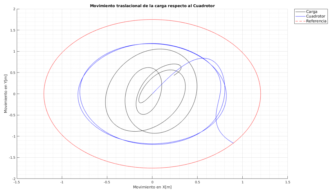
Figura 5.19: Movimiento Circular del Cuadrotror con Carga Suspendeda de m_L = 68g y con longitud de cable m_L = 70cm
