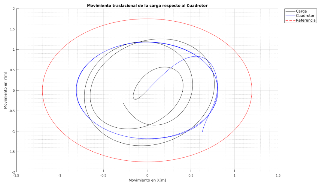
Figura 5.23: Movimiento Circular del Cuadrotror con Carga Suspendeda de m_L = 108g y con longitud de cable m_L = 70cm
