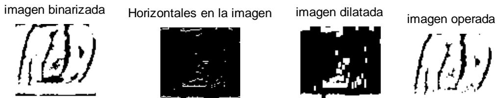
**Figura 60.** Proceso de limpieza de la imagen binarizada.
