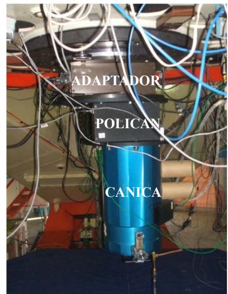
Figura 3.- Fotografía de POLICAN y CANICA montados en telescopio.
