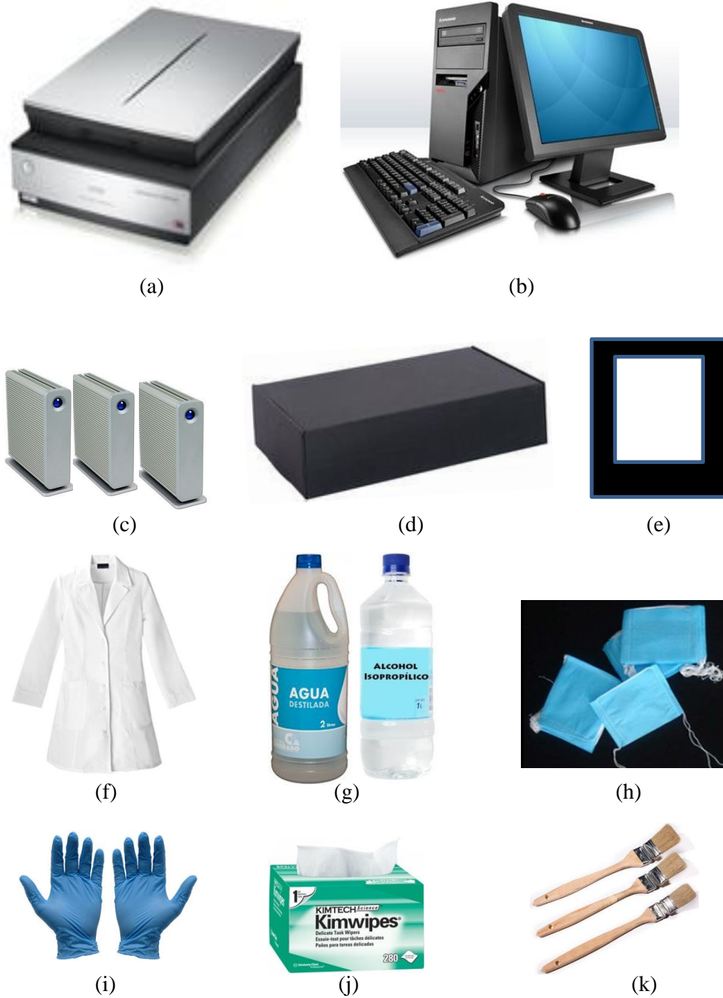
Figura 13. Material utilizado, a) Escáner Epson Perfection V750 Pro , b) Computadora con el software SilverFast Ai , c) Discos duros externos, d) Caja negra, e) Plantillas portaplacas, f) Bata de algodón, g) Agua destilada y Alcohol isopropílico, h) Cubre bocas, i) Guantes, j) Paños para tareas delicadas, k) brochas antiestáticas.
