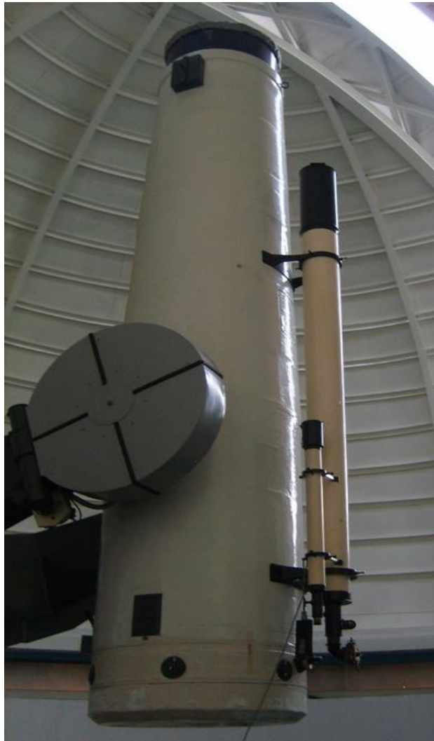
Figura 2. Cámara Schmidt (obtenida de [1])
