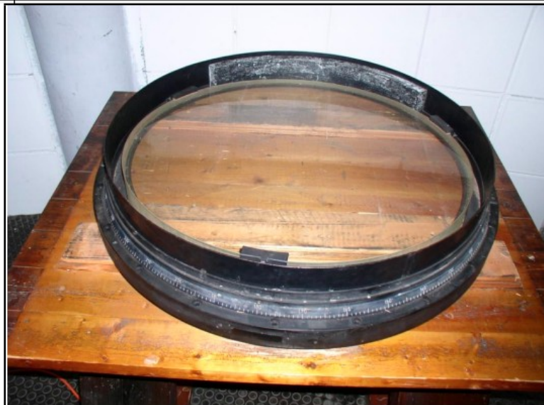
Figura 4. Prisma objetivo de la Cámara Schmidt.
