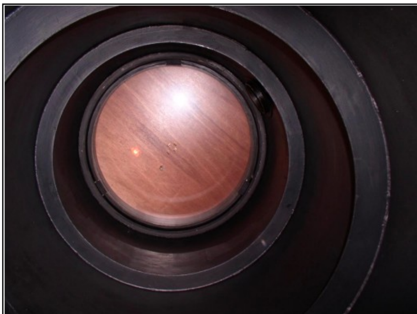
Figura 2. Placa correctora de la Cámara Schmidt.
