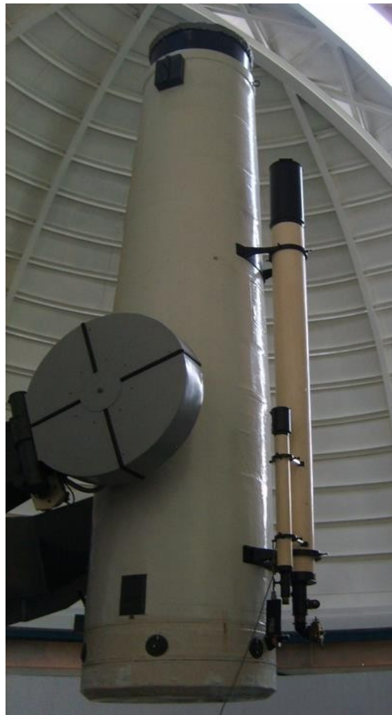
Figura 1. Cámara Schmidt (obtenida de [1]).
