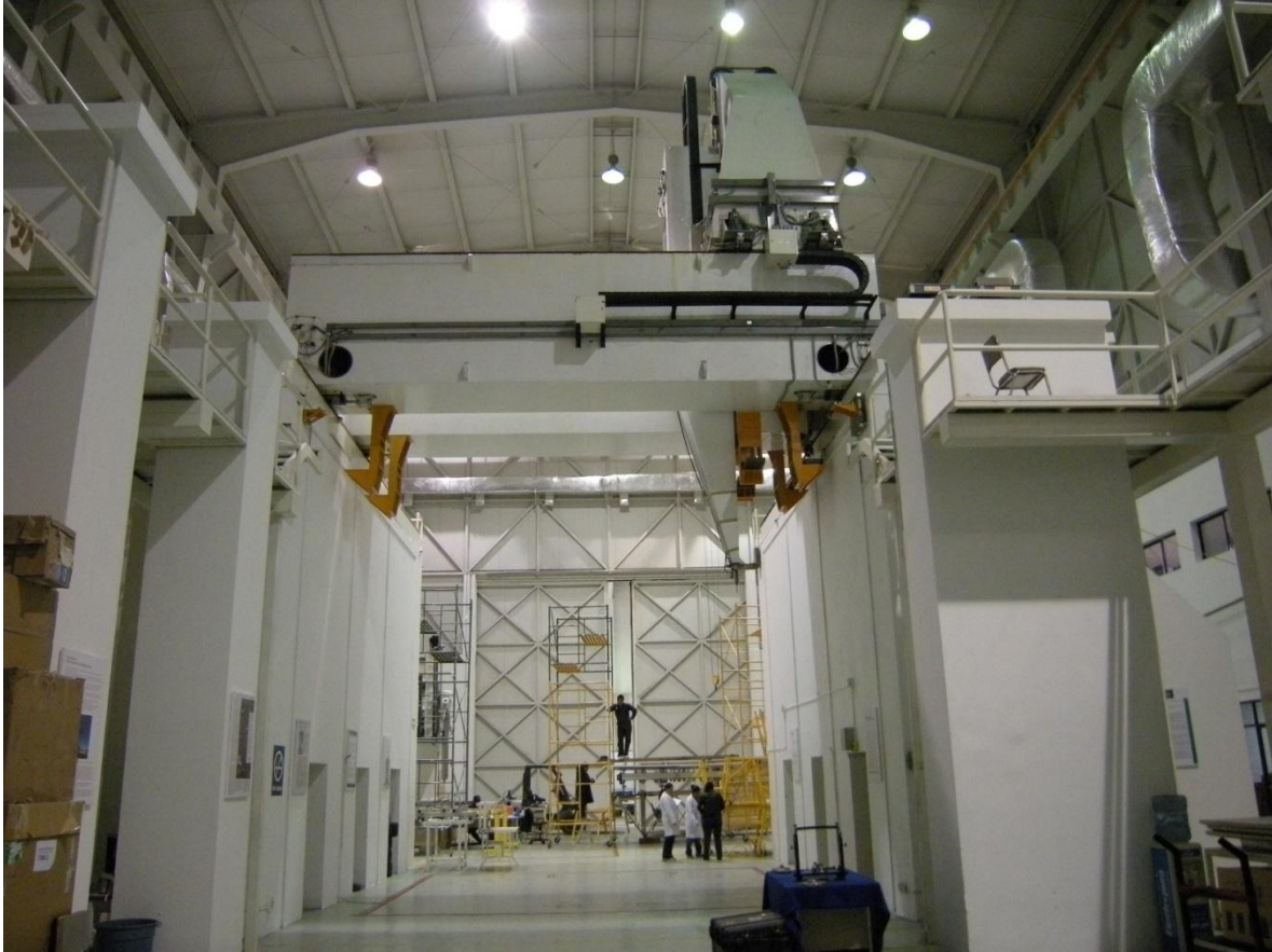
FIGURA 2. Máquina de medición por coordenadas (MMC) del INAOE
