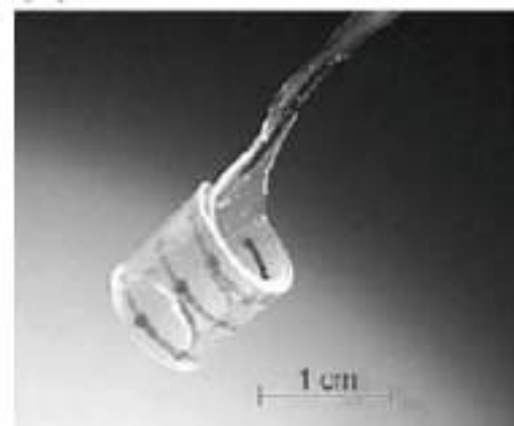
Figura 2.7: Microelectrodos basados en polímeros. Extraído de [22].
