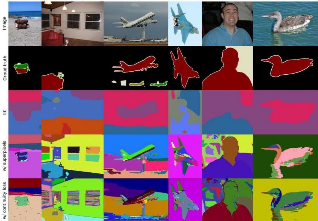
Figura 4.4: Comparación de los resultados de segmentación no supervisada, donde los distintos segmentos se muestran en colores diferentes. [33]
