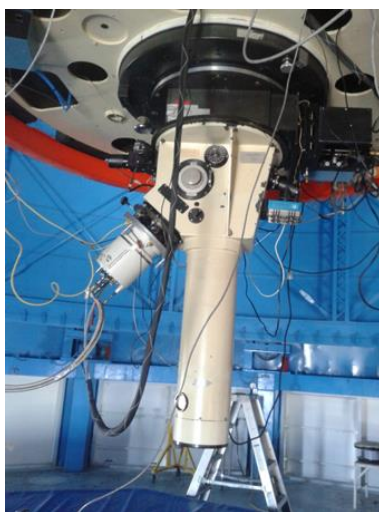
Figura 3.1: Espectrógrafo Boller & Chivens.
