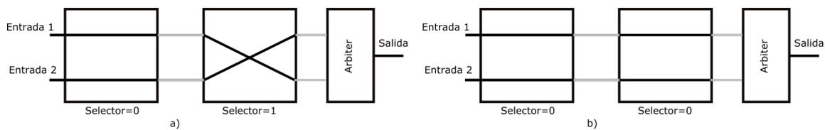
Figura 2.17: Arbiter PUF con bloques de conmutación.
