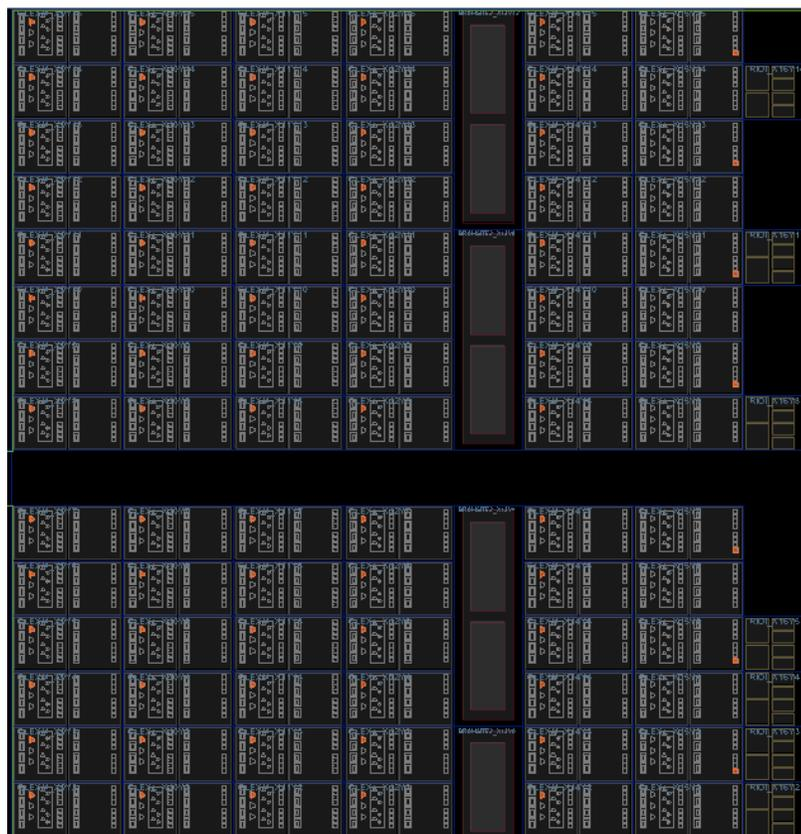
Figura 3.10: Ubicación de los componentes primitivos en la FPGA.
