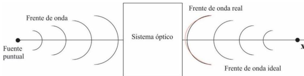
**Figura 8.- Formación de imágenes en un sistema óptico comparando en el espacio imagen los frentes de onda reales con respecto al ideal [26].**
