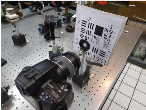
**Figura 43.- Arreglo empleado para adquisición de imágenes.**
