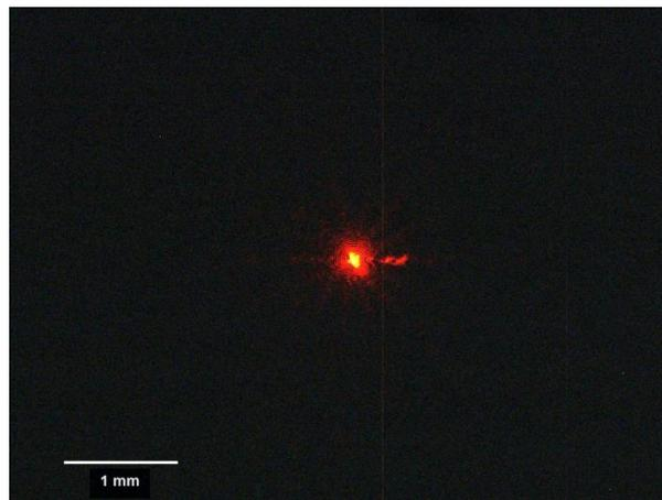
**Figura 40.- Transformada de Fourier óptica de la lente oftálmica 10 dioptrías.**
