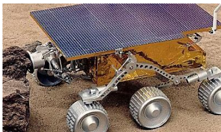
Figura 2.7 Sojourner Rover y su sistema de locomoción Rocker-Bogie. Créditos: Madrid Deep Space Communications Complex (MDSCC)
