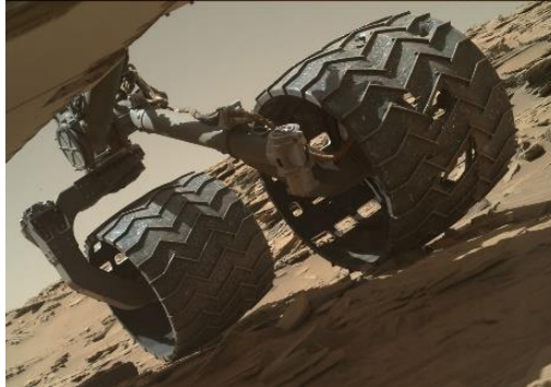
Figura 1.1 Llanta de Rover y sus daños a lo largo del tiempo. Créditos: NASA/JPL-Caltech.
