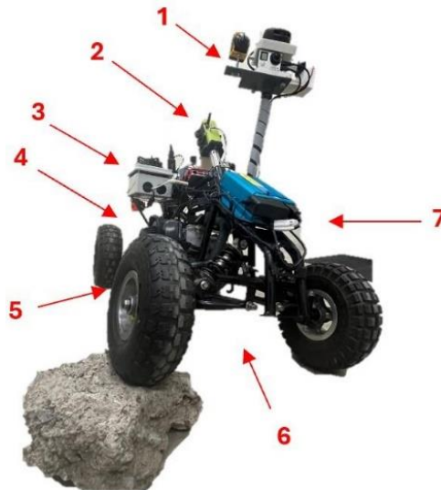
Figura 5.4 Prototipo INAOE-AI-ROVER-01. Elementos, características y propósito de operación.
