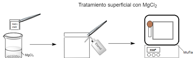
Figura 23. Tratamiento superficial en soluciones de MgCl 2 a fotoánodos de TiO 2 y ZnO y tratamiento térmico.
