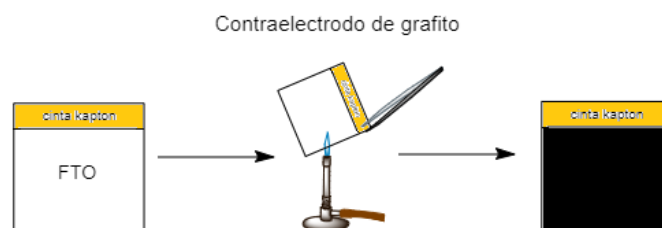
Figura 18. Fabricación de contraelectrodo de grafito.
