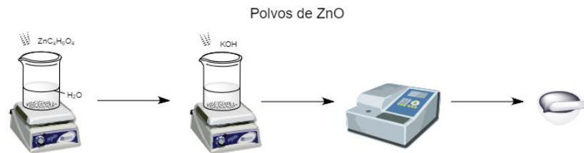
Figura 21. Síntesis de polvos de ZnO por método modificado de solvo-precipitación.
