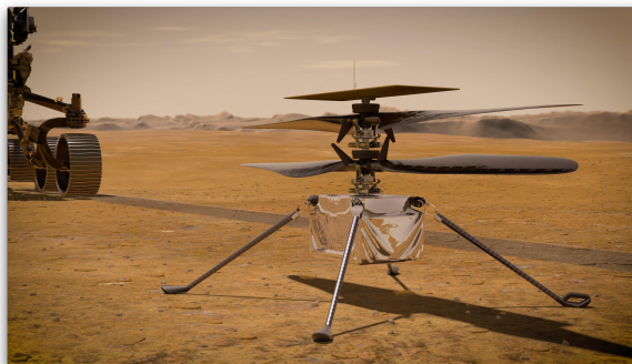
Figura 3.2: Ilustración del helicóptero Ingenuity en la superficie de Marte. Tomada de NASA/JPL-Caltech.
