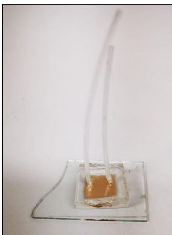
Ilustración 30 Chip usado para disminuir errores de medición en el biosensor.
