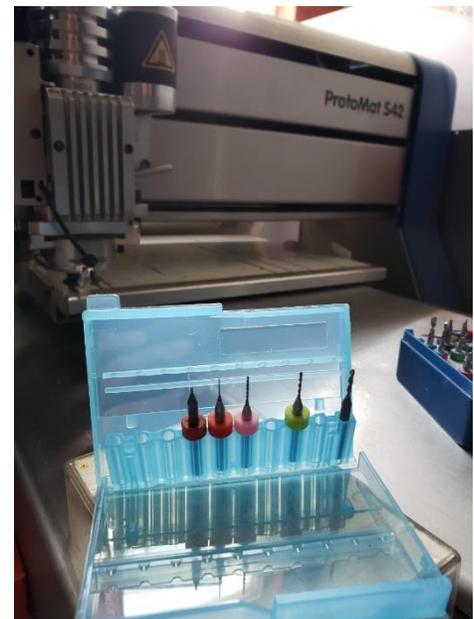
Figura 23. Software y hardware utilizados en el desbaste del circuito impreso.
