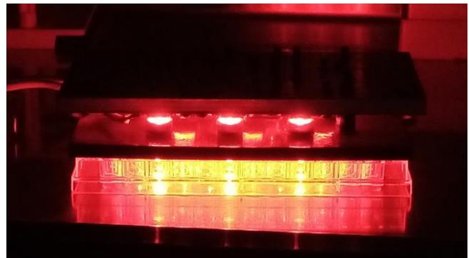
Figura 41. Dispositivo de irradiación para estudios *in vitro*.
