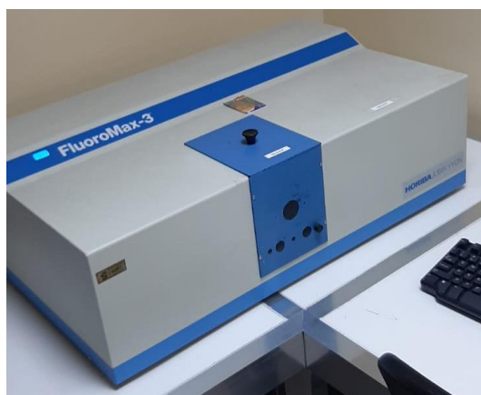
Figura 16. espectrómetro de fluorescencia FluoroMAx-3 utilizado para realizar las mediciones de fluorescencia de las GFP.
