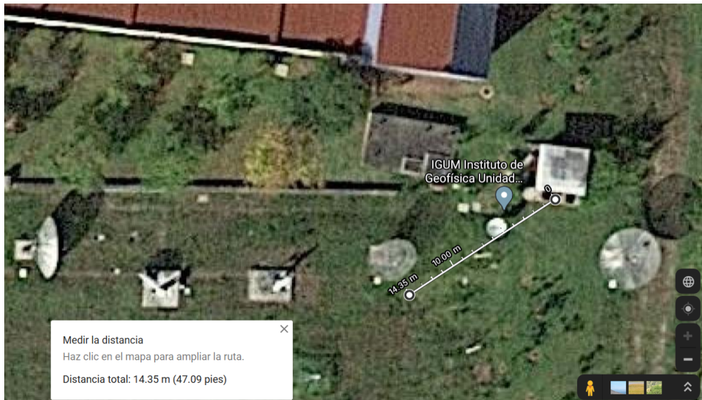
Figura 4.2: Mapa de la posición y línea de base de las antenas receptoras. Extraído de Google Maps.
