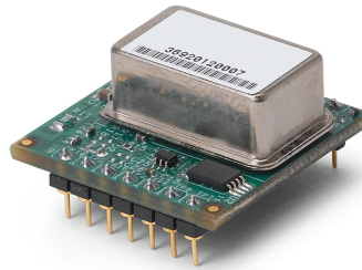
Figura 4.14: GPSDO de montaje compatible con USRP X300 y X310. Tomado de: https://www.ettus.com/all-products/gpsdo-mini/
