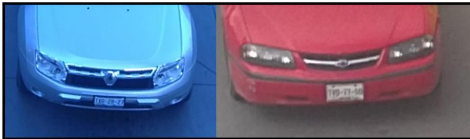
Figura 2.8. Matrícula distorsionada por el ángulo de toma.
