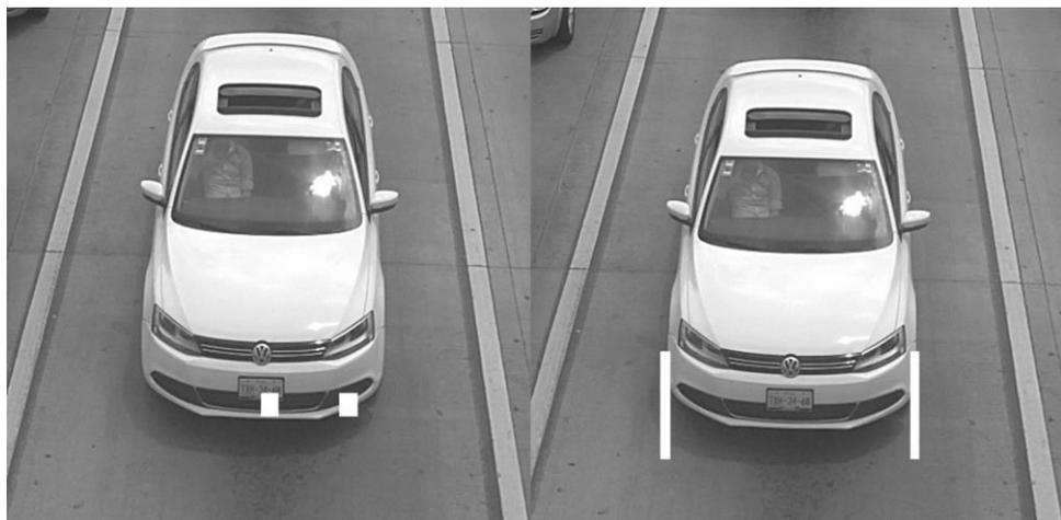
Figura 3.2. Ejemplo de salida del sub-módulo de localización de sombra durante depuración.
