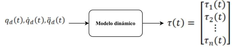
Figura 2.8: Esquema del modelo dinámico inverso.
