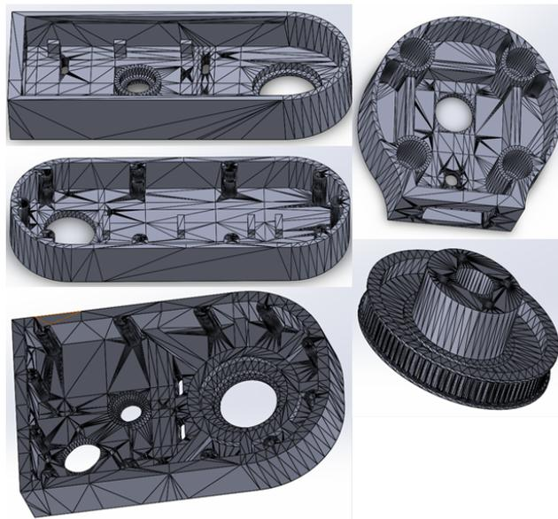
Figura B.2: Diseño de piezas en 3D para el robot manipulador SCARA.
