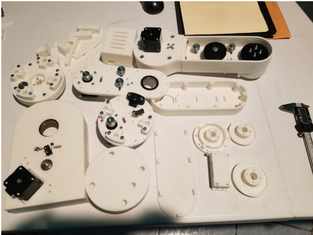
Figura B.3: Piezas fabricadas para el robot manipulador SCARA, a base de filamento PLA.
