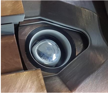
Figura 54. Crisol de aluminio con pellets de aluminio del ultra alta pureza en el pocket del cañón de electrones.
