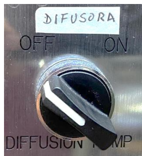
Figura 14. Interruptor de encendido y apagado de la bomba difusora.
