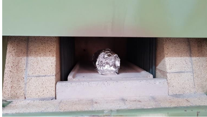
Figura 36. Sellado del tubo de apoyo
