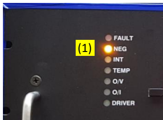
Figura 24. LED que indica el tipo de cañón de electrones, cuando se enciende el led, quiere decir que es negativo.
