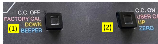
Figura 7. Interruptor de encendido (2) y apagado (1) del sensor de cátodo frio etc.
