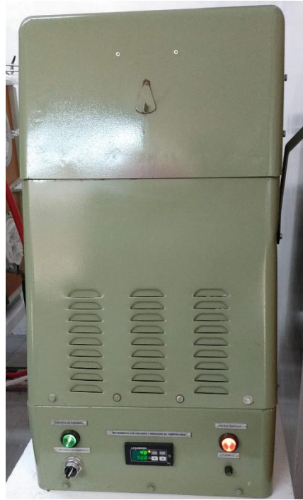
Figura 34. El horno, TIPO- 51449, serie: 01103, que alcanza 1110 grados °C de calentamiento.
