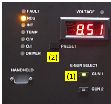
Figura 25. Botones del cañón de electrones para determinar el voltaje y corriente inicial.
